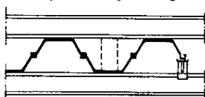
Stalowa rama prowadząca dla grodzic typu Z
