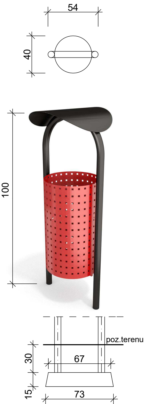
Fundament - sposób montażu
